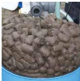
FIBALON® wwt weist eine ausgezeichnete Trennschärfe von 10 µm auf und ist besonders leicht zu entsorgen. Insbesondere, wenn es auf das Filtrationsergebnis und eine gleichbleibende Filtrationsqualität ankommt, ist die drucklose Partikelabscheidung von FIBALON® wwt die beste Wahl.
